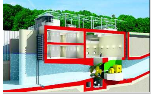
Das Krafthaus: Gelb die beiden Turbinen, in die von rechts das Wasser einströmt. Grafiken (2): Weserkraftwerk GmbH
